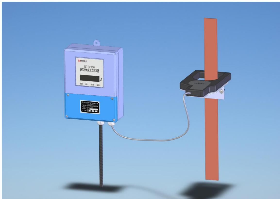
如上图，电流互感器采用夹具直接安装至铁芯接地引下线上；监测装置本体根据现场不同条件，通过安装附件安装至合适位置。引线电缆可通过防水波纹管进行防护。
