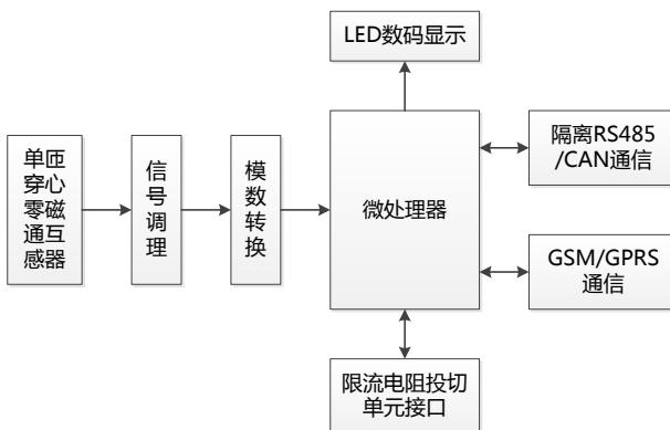
变压器铁芯接地电流通过穿心式电流互感器隔离变换为小信号，经信号转换、滤波与放大等调理电路，由模数转换器变换为数字信号，微处理器经过数字滤波与运算获得铁芯接地电流；本地显示接口可显示实时接地电流，当超过报警限值时具有 LED 指示；装置可通过隔离 RS485/CAN/GSM/GPRS 通信接口（订货时选择）与状态监测系统等后台实时通信。
